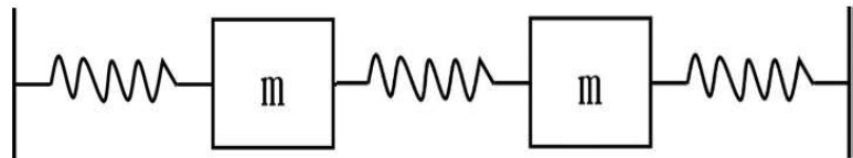
圖 33：兩質量+三彈簧振動模型
